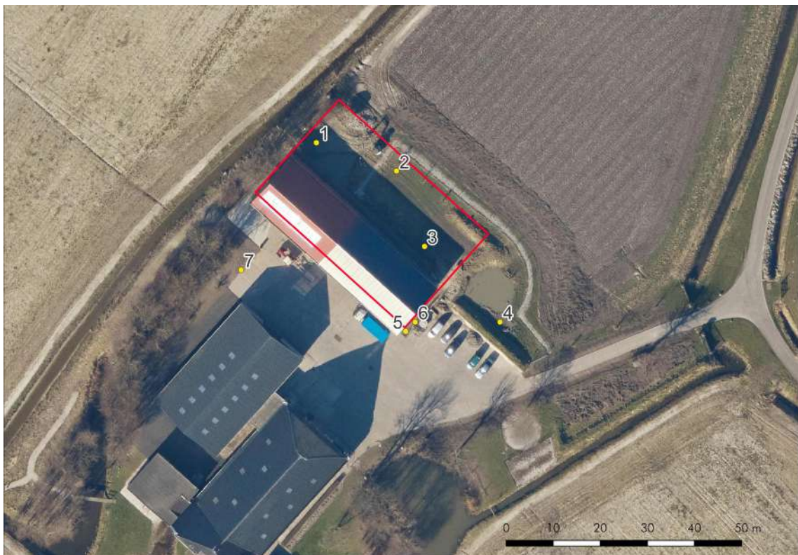
Figuur 10: Paesens, Orneawei 3: boorpuntenkaart met als achtergrond een kaart van Opentopo. Het plangebied is rood omlijnd, de boorpunten worden weergegeven met gele stippen.
