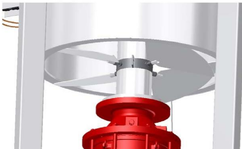
Afbeelding 8: Verbrandingsluchttoevoerregeling dmv. luchtkleppen
