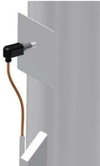
Afbeelding 11: UV Sonde, Montage zijdelings aan vlampijp + Hitte afscherming
