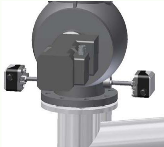
Afbeelding 15: Montageplaats van de drukschakelaars op de gasklep
