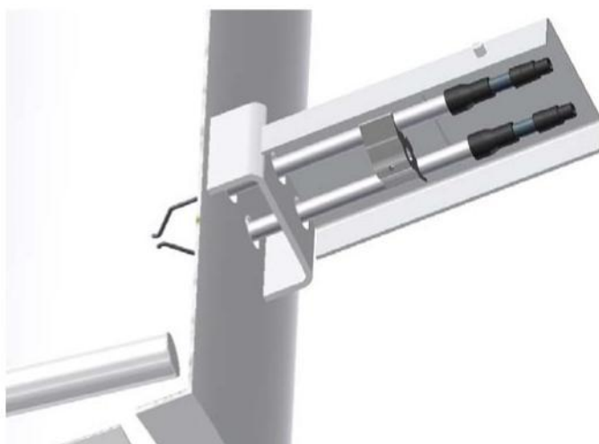
Afbeelding 10: ontstekingselektroden incl. houder in ingebouwde toestand . Aanzicht van onderen
