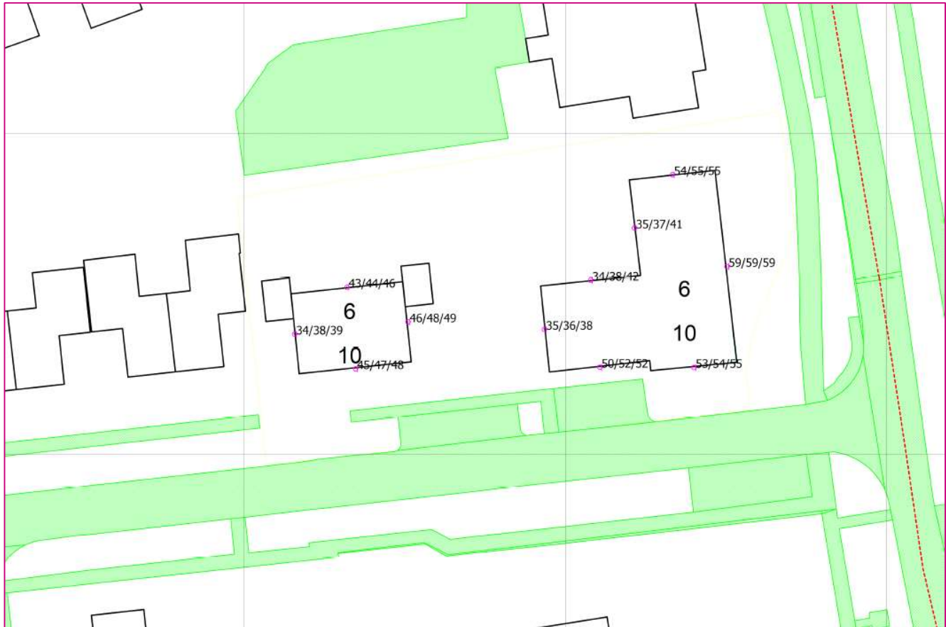
Figuur 5: overzicht van de berekende geluidbelasting vanwege L_{den} in dB vanwege de gehele Hantumerweg, exclusief 5 dB aftrek op basis van artikel 110g Wgh (30 km-gedeelte en 50 km-gedeelte)
