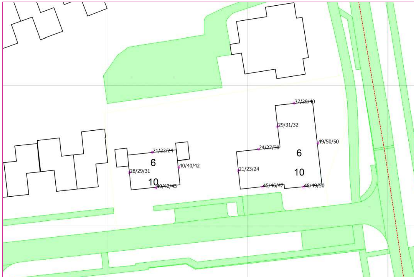
Figuur 4: overzicht van de berekende geluidbelasting vanwege L_{den} in dB vanwege de Hantumerweg, inclusief 5 dB aftrek op basis van artikel 110g Wgh (30 km-gedeelte)
